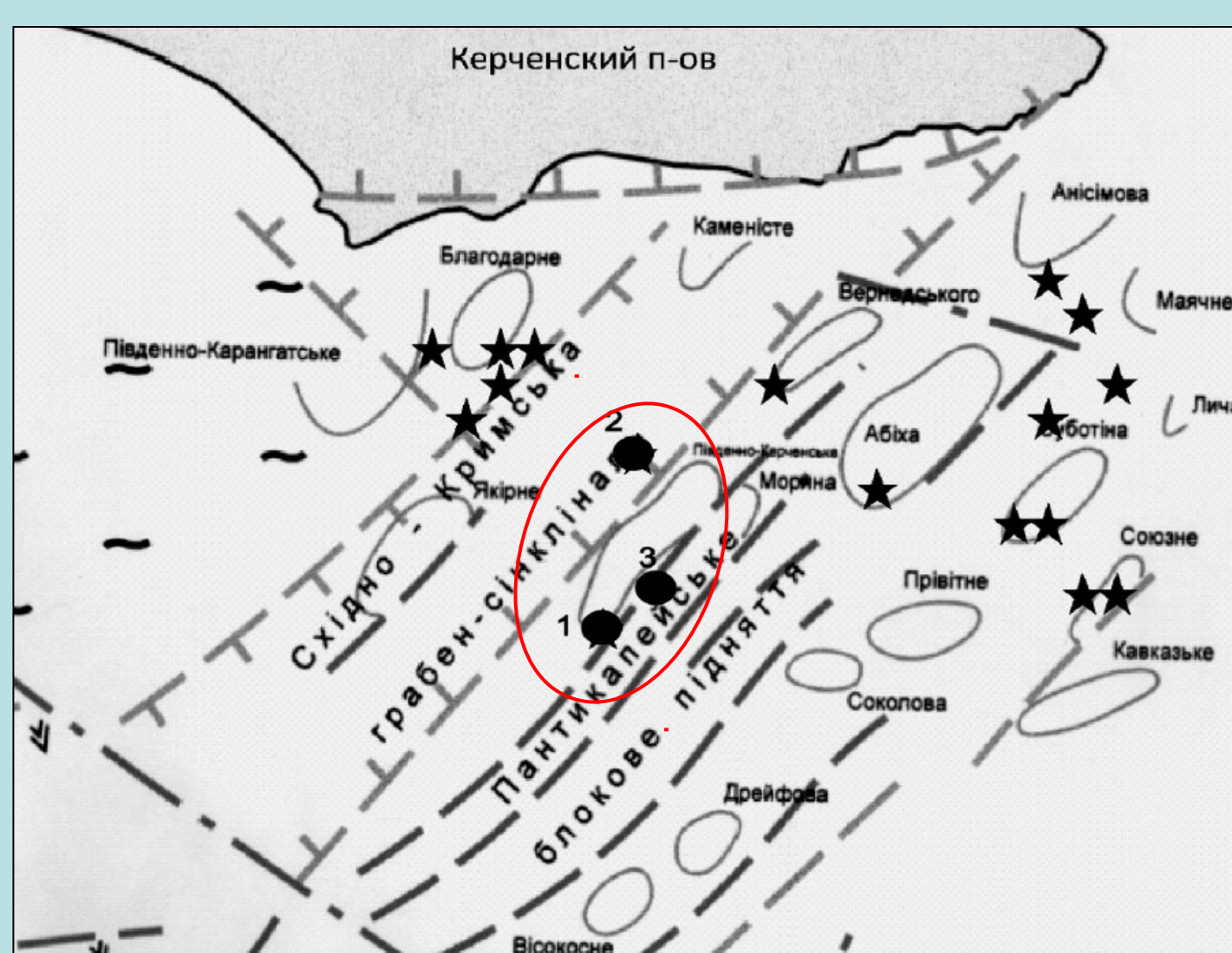
Рис. 4. Грязевые вулканы на тектонической схеме Прикерченского участка крымского шельфа (составлена с использованием данных ПГО «Укргеофизика», 2009). Грязевые вулканы: 1 – Митина, 2 – ОМГОР, 3 – Науменко; звездочки – грязевые вулканы, выявленные геофизическими методами [7].
